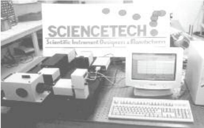
**Model 7336 Steady State Fluorometer System**
